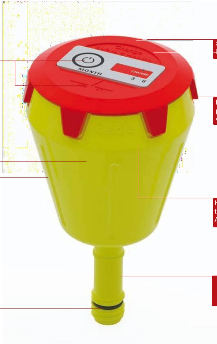
Die Aktivkohlefüllung des b.safe Abluftfilters adsorbiert gesundheitsschädliche Dämpfe aus gesammelten Lösemittelabfällen. Nur gefilterte Abluft entweicht über die Belüftungsöffnungen an die Umgebung.
