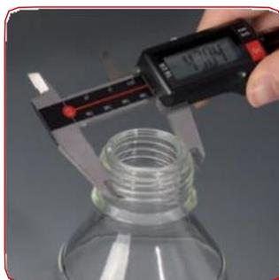
Gewindemessung an einer Flasche
