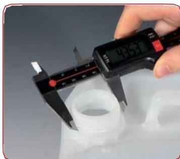
Gewindemessung an einem Kanister
